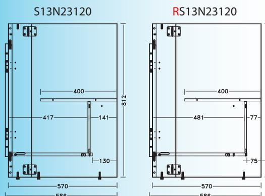
Pour bénéficier d'un vide-sanitaire réduit de 75 mm et ainsi permettre l'intégration d'une poubelle sélective supérieure à 7,5 litres, dans le meuble sous-évier DECLIQ, il convient de rajouter un **R** devant le code article.
