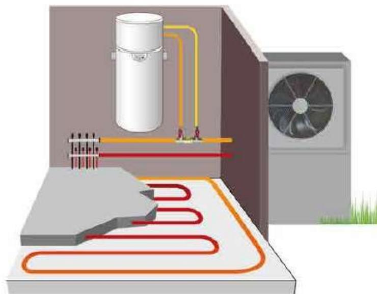
*En hiver, Edel EAU prélève les calories gratuites de l'air extérieur, par l'intermédiaire du générateur qui alimente le plancher chauffant, pour produire l'eau à 60° C.*
