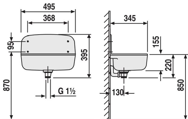
Poste d'eau avec trop plein, et doseret, fabriqué en matériau de synthèse résistant aux chocs, à la température et aux intempéries, capacité approximative 13.5 l, complet avec trop plein, bonde à grille G de 1 1/2", et fixation murales, emballé individuellement.
